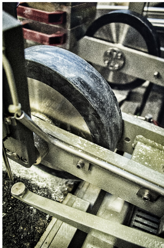
Koleinierz mały – badanie odporności na koleinowanie
